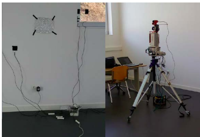
Figura 12. a) sensores de superficie y dispositivo HOBO. b) montaje de escáner y cámara termográfica
