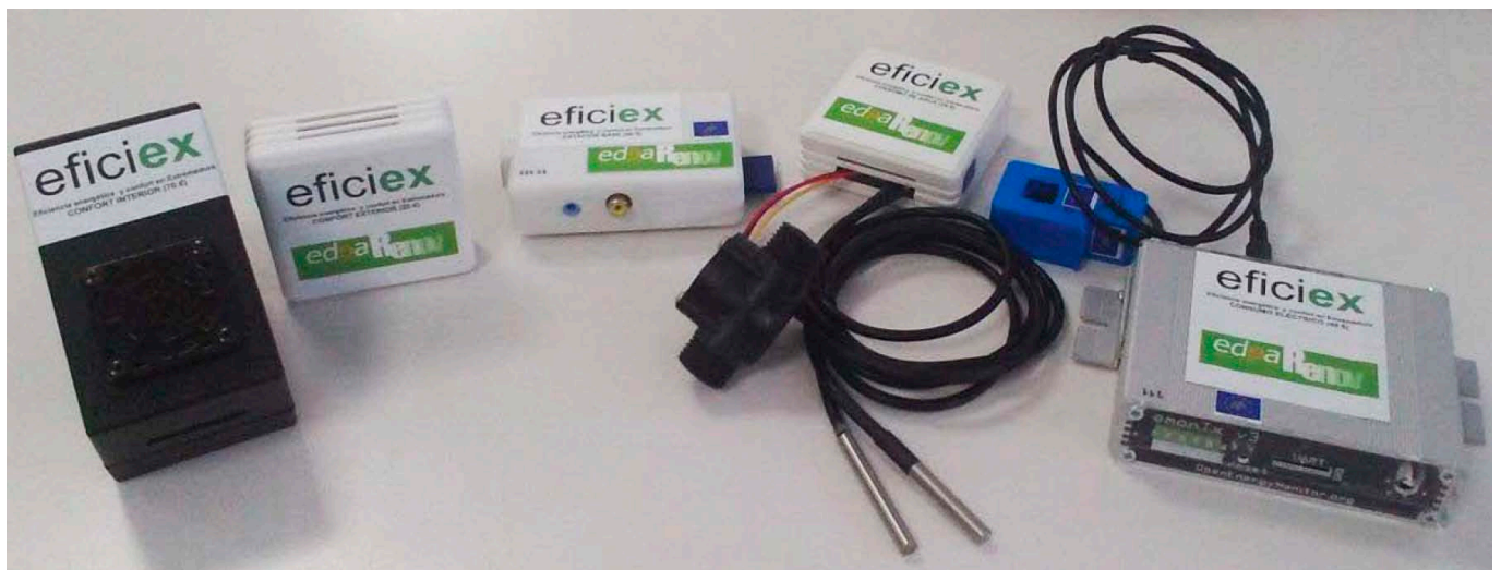
Figura 2. Sistema de monitorización EFICIEX. De izquierda a derecha: Sensor de confort interior (temperatura, humedad y calidad del aire); Sensor de confort exterior (temperatura y humedad); Estación base (Raspberry Pi); Sensor de consumo de agua-gas y consumo eléctrico.
