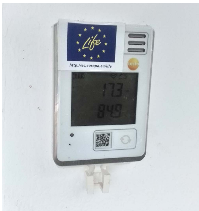
Fig 17. Registrador de datos Testo 160 IAQ utilizado en la toma de datos
