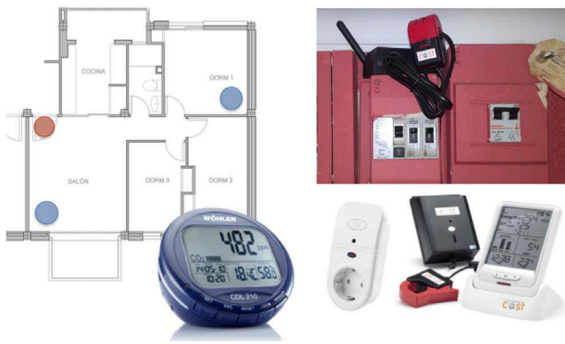
Figura 5. Sistema local de simulación. Situación equipos de monitorización de variables ambientales y energéticas.
