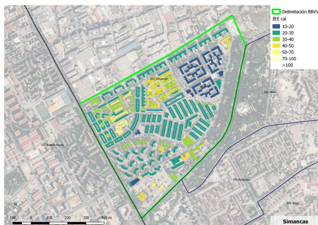
Fig 11: Indicador de pérdidas energéticas calculado para todos los edificios del barrio de Simancas mediante la herramienta MEPEC
