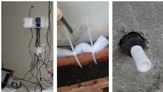
Figura 4. Disposición de sensores en el cerramiento en diferentes estratos del cerramiento
