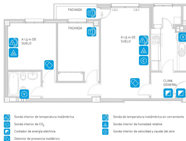
Figura 4. Esquema del sistema de monitorización de una vivienda.
